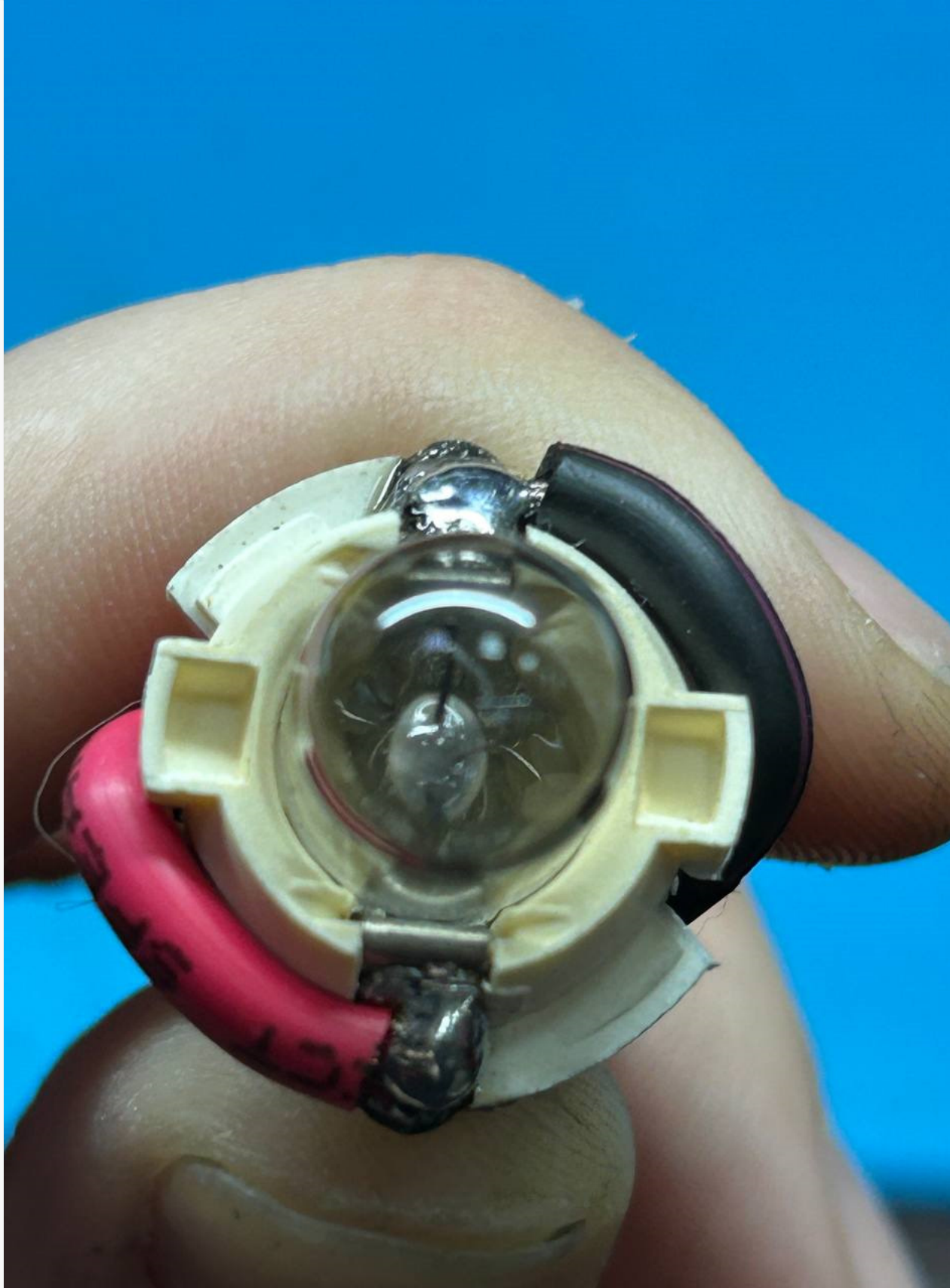
Провода от лент припаиваем к цоколю таким образом.
