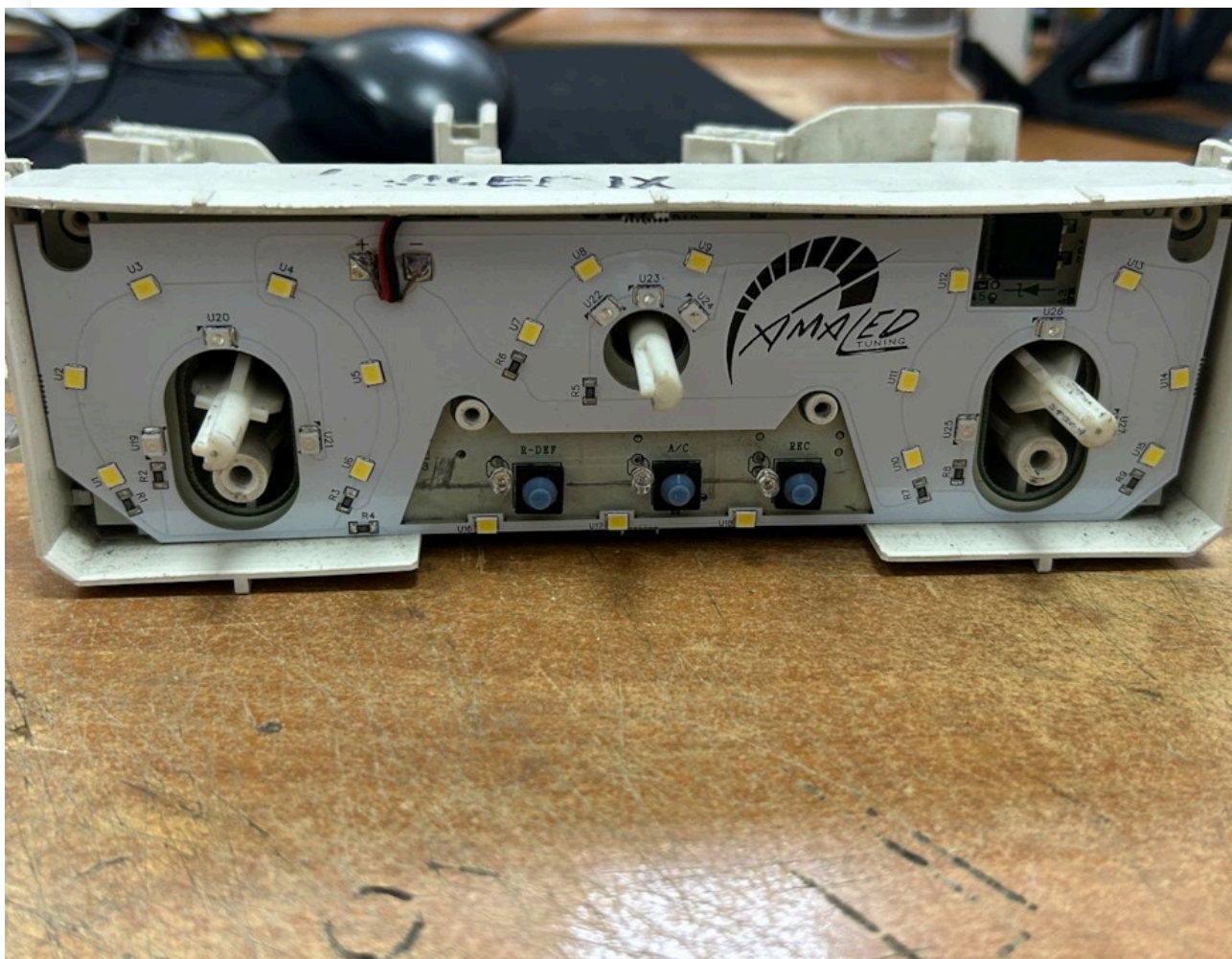
Устанавливаем плату подсветки и выводим провода на заднюю часть блока печи.
